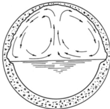
這些新生長的菌株稱為硫桿菌，也是他們造成污水水道內 MIC 的形成。硫桿菌會攝取硫化氫並分泌硫酸。當環境越來越酸，更強悍的菌株會取代較弱菌株，演替第六次的菌株叫做氧化硫硫桿菌，此菌株可以存活在 pH 0.5 的高度酸性之下，等同於 7%濃度的硫酸。這種強悍的菌株經常生長於污水下水道的最頂端。左圖圖示硫化氫在水管內的循環。
